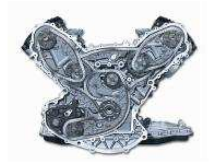
Komplexer Steuer- und Ölpumpenrieb
